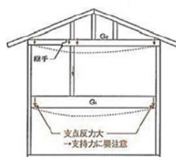
図11 ●軸組図による継手位置の検討
